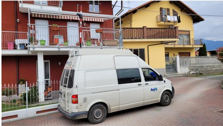
Foto 1: Laboratorio mobile, sensore posto ad una quota di circa 4.5 m
